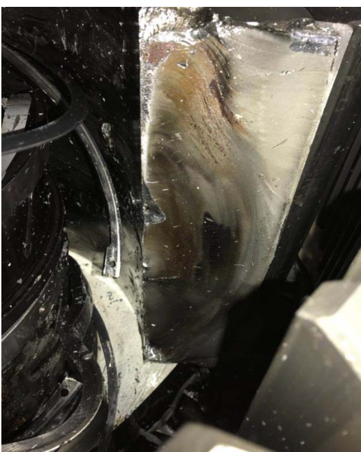
图四：行星轮断面局部
